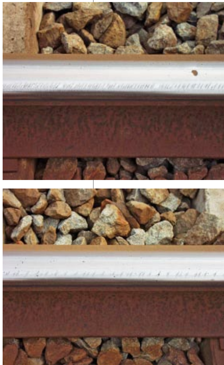
Bild 1: Headchecks an der Fahrkante, unten: moderat, oben: ausgeprägt
