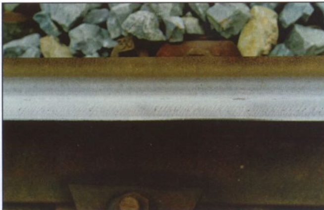
a: moderate head checking
