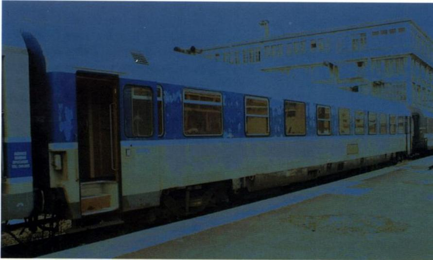
**Fig. 13** - Voiture Hélène d'enregistrement des installations électriques et de signalisation (IES)
