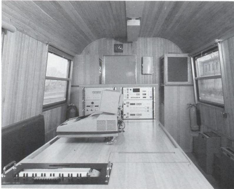
Le véhicule d'enregistrement SM 775 est doté d'un équipement d'analyse de la surface des rails pour l'établissement des programmes de "meulage"
