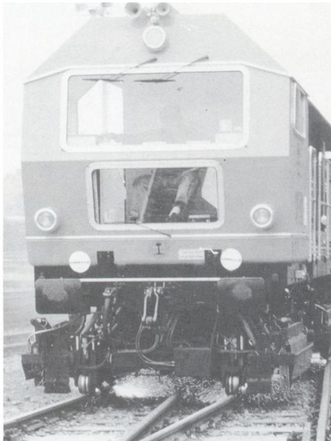
RR 16 P-D - Le meulage des aiguillages est effectué par des machines spéciales
