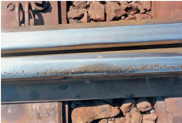
Bild 1: Rollkontaktermüdung an einer Weichenzunge
