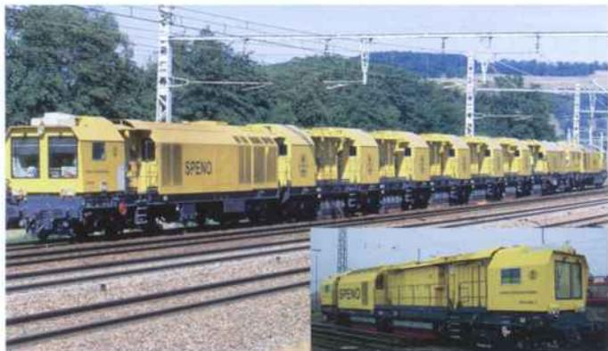
Abb. 6: Moderne Schleifmaschinen für Strecke und Weichen
