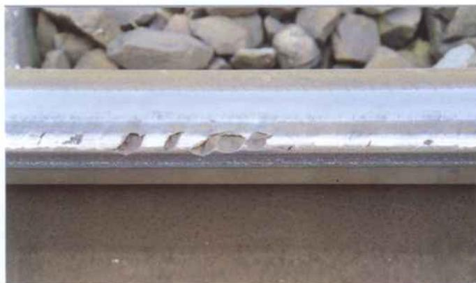
Abb. 8: Fahrkantenermüdung
