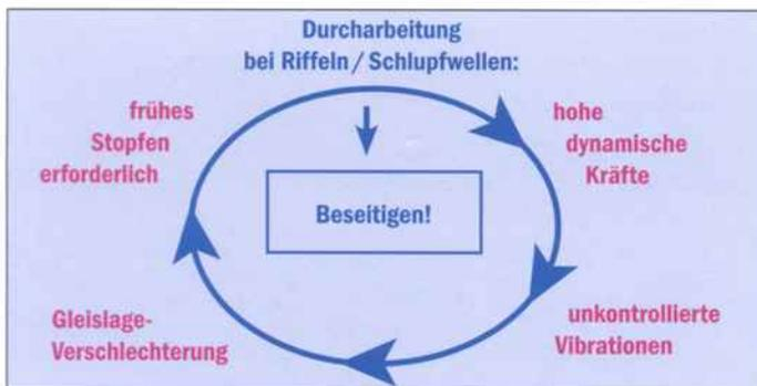
Abb. 14: Zusammenhang Gleisdurcharbeitung – Schienenschleifen
