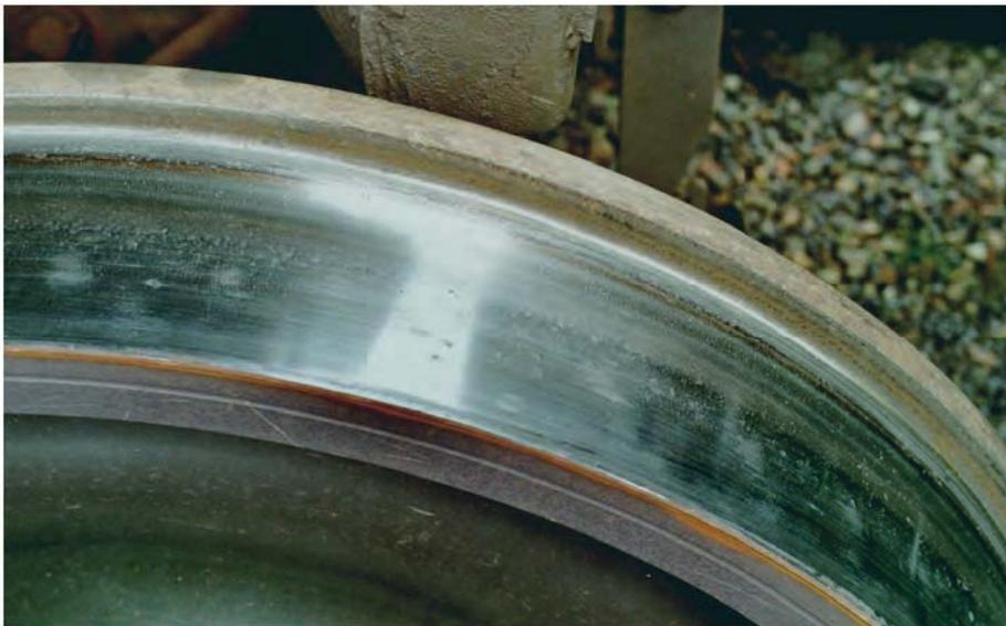
Abb. 4: Schädigungen der Radlaufläche
