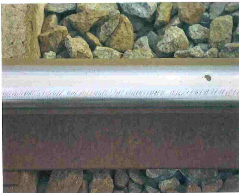
Bild 4: Typische Headcheck-Bildung an der Fahrkante
