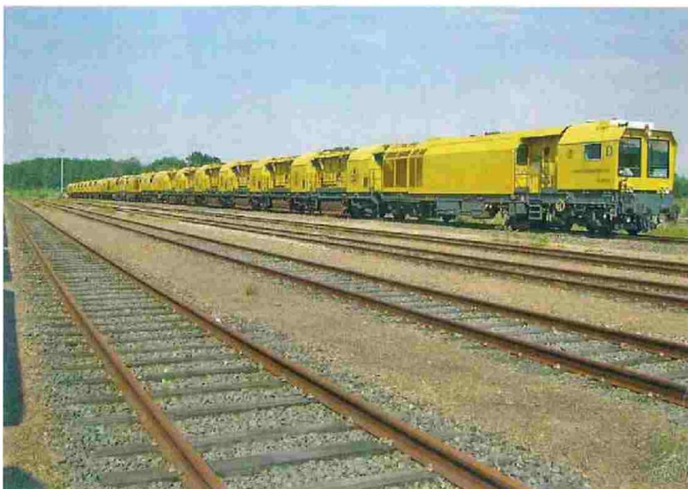
Bild 7: Schleifzüge RR48 M-2 und RR48 M-3 gekuppelt für One-Pass-Grinding
