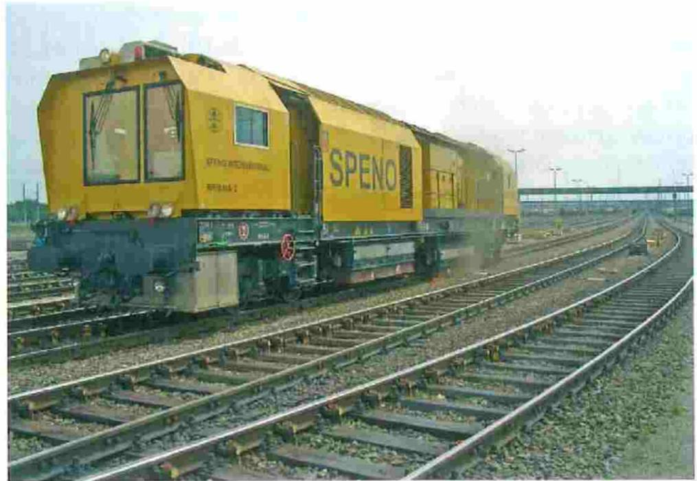
Bild 8: Maschine RR16 MS-2 zur Bearbeitung von Schienen in Weichen
