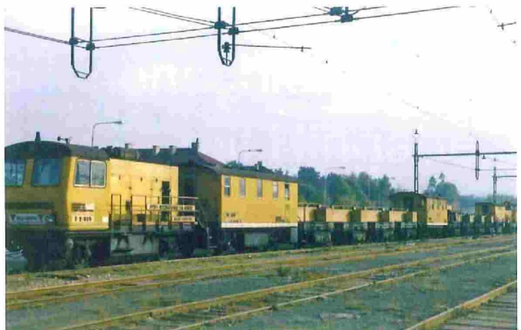
Bild 2: Schienenschleifmaschine TRR835 mit 56 fest angeordneten Schleifmotoren (Aufnahme von 1984)
