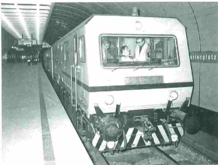
Bild 3: Schienenschleifmaschine URR 28 E/S-3 (Aufnahme 1982, ganz rechts der Autor)
